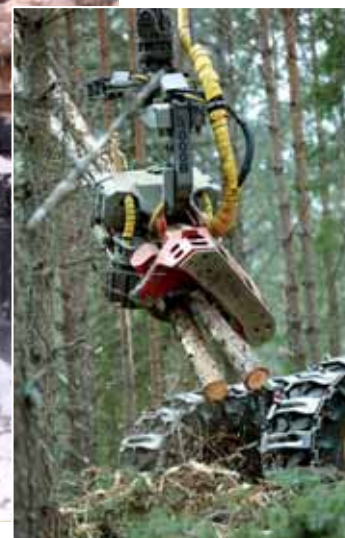
Flerträdshantering vid gallring ökar produktiviteten med 30 procent jämfört med vanliga skördare.
