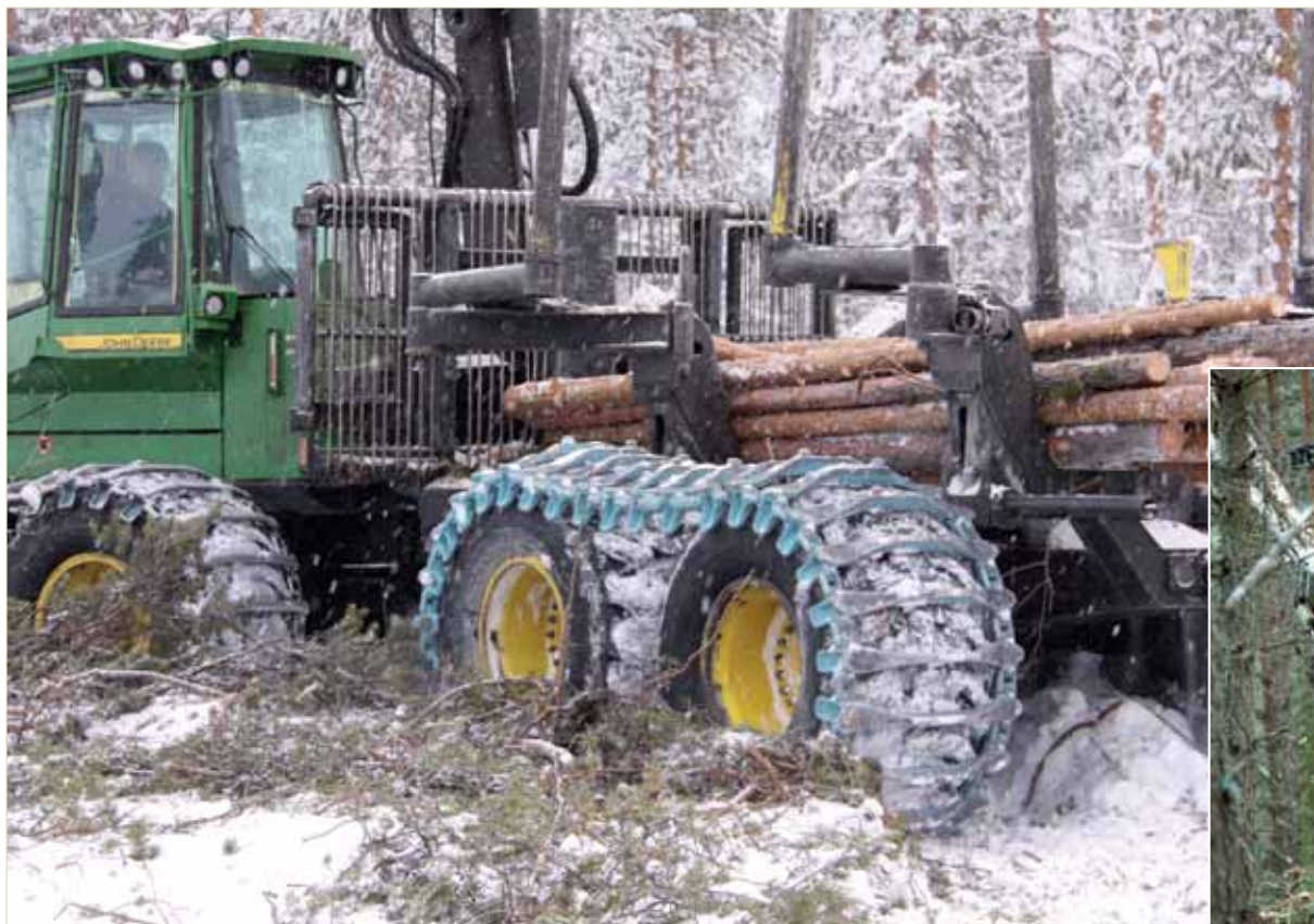
Under 2010 testade Sveaskog ett nytt metallband på däck till våra skotare som ger bättre framkomlighet och minskar slitaget.
