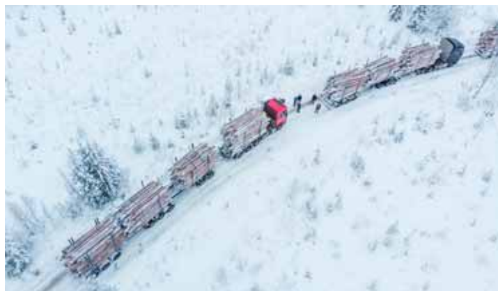
Ett exempel på ett branschöverskridande samarbete är mellan Sveaskog och Volvo Lastvagnar. Bolagen genomför tester för att möjliggöra timmertransporter på upp till 90 ton från skog till lastterminal. Med mer last i varje fordon ökas effektiviteten, kostnaderna sänks och koldioxid-utsläppen minskas med upp till 20 procent.
